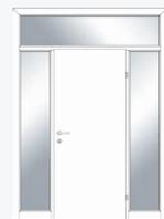
2 Seitenteile, 1 Oberteil, Türblatt rechts/links angeschlagen
