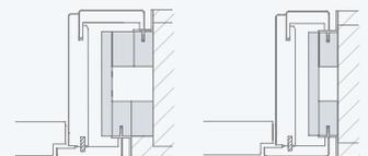
**MAGNETFALLE:** Optional erhalten Sie auch ein Magnetfallenschloss. Hierbei wird die Schlossfalle durch einen in der Zarge integrierten Magneten angezogen.
