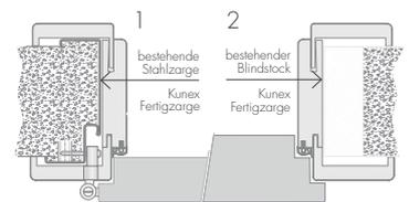
Bei beiden Lösungen reduziert sich die Durchgangslichte um 50 mm in der Breite bzw. 25 mm in der Höhe. Weiters verschiebt sich die Lage des Türblattes um ca. 15 mm.
