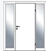
2 Seitenteile, Türblatt rechts/links angeschlagen
